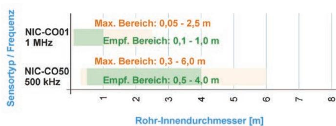
Abb. 18-3 NIC-CO (Clamp-On Sensor) und passende Rohr-Innendurchmesser
