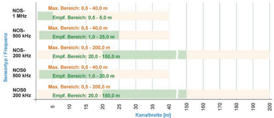
Abb. 18-1 NOS-/NOS0 (Stab-, (Halb-)Kugelsensor) und passende Kanalbreiten
