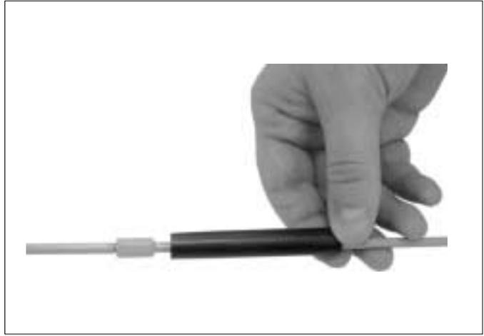
b) bei Gefahr von Brückenbildung (z.B. wenn zwei Verschraubungen sich auf gleicher Höhe befinden) Schrumpfschlauch aufschieben
