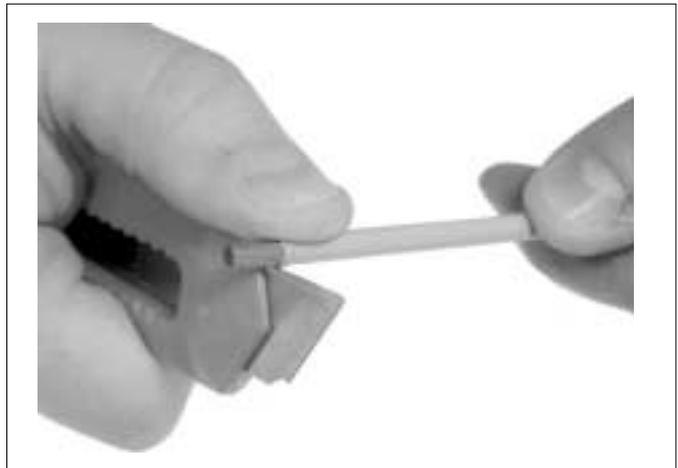
b) mit einem Messer das Sondenende (ca. 1cm) abisolieren
