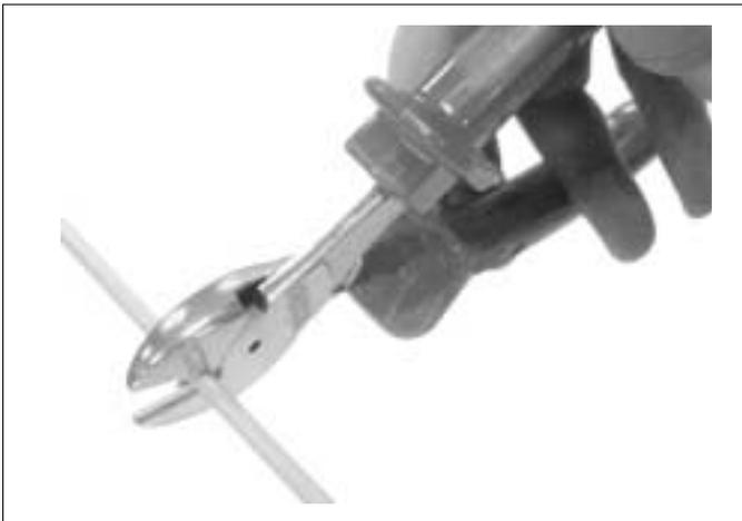
a) mit geeignetem Werkzeug den Stab auf die gewünschte Länge kürzen
