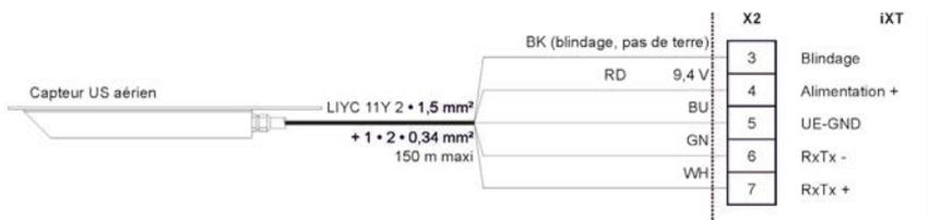
**Fig. 22-10 Capteur ultrason aérien OCL sur iXT02xx/4xx**
