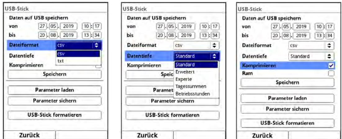
**Abb. 32-7 Datenformat / Datentiefe / Komprimierung**
