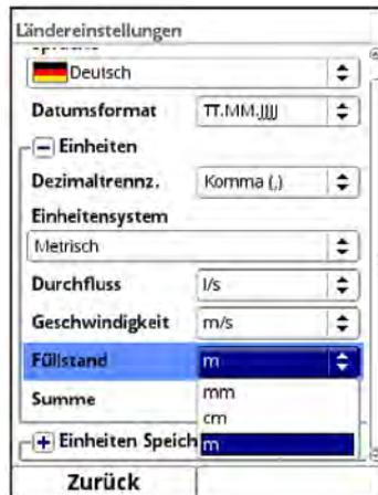
Abb. 31-5 Einstellung der Maßeinheiten
