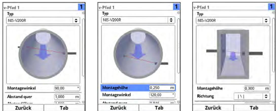
**Abb. 31-11 Sensormontage „Benetzt“ im Rohr bzw. Rechteck**
