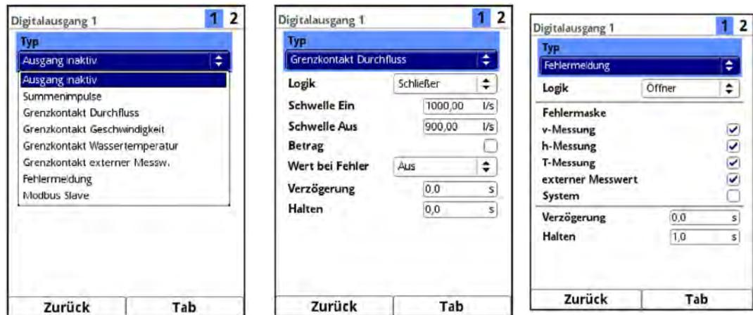
Abb. 31-16 Digitalausgänge: Aktivierung / Grenzkontakt Durchfluss / Fehlermeldung
