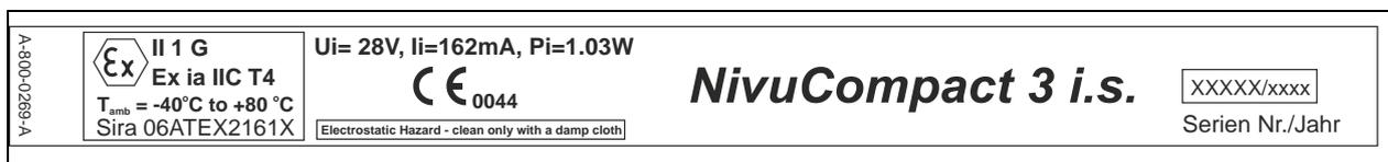
Fig. 3-2 Plaque signalétique du NivuCompact 3 i.s. avec agrément Ex
